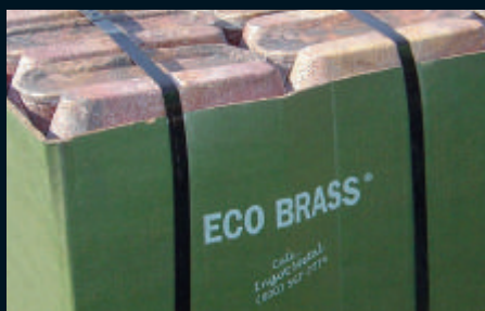
Lingots en ECO BRASS MD servant à la production de pièces coulées sans plomb.
